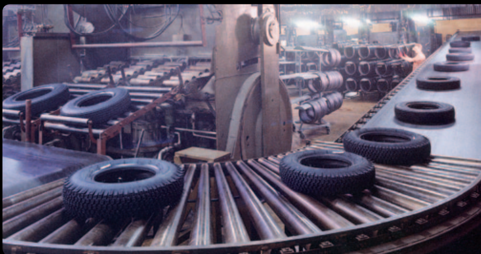
Tuoreet renkaat siirtyvät paistomuoteilta kuljettimelle. Uusi rengastehdas 1970-luvun alussa. Kuva Pauli Lehtioksa.
